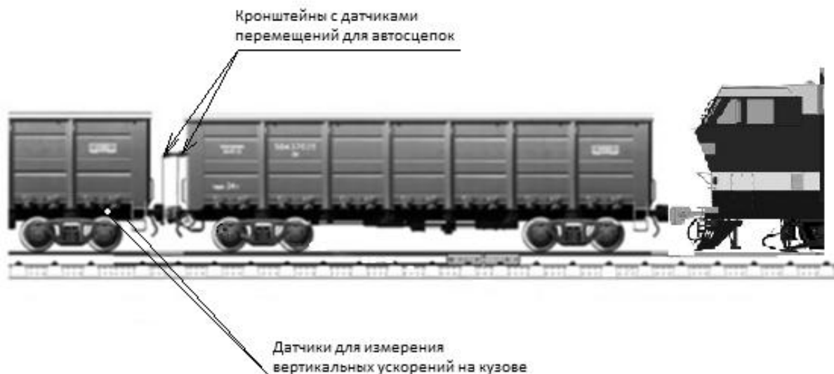
Рисунок 1.6 – Схема размещения датчиков на опытном вагоне.
