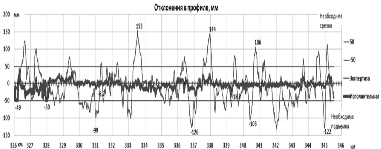
Рисунок 1.14 – Исполнительная съёмка измерительной тележкой Trimble участка Бушевец – Академическая Октябрьской железной дороги.
